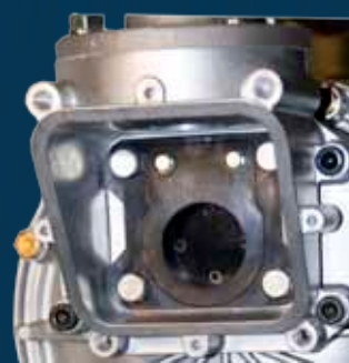
Pouhé 4 šrouby k zajištění přístupu ke klapkovému ventilům
