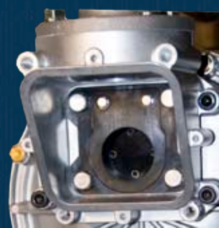
Pouhé 4 šrouby k zajištění přístupu ke klapkovému ventilu
